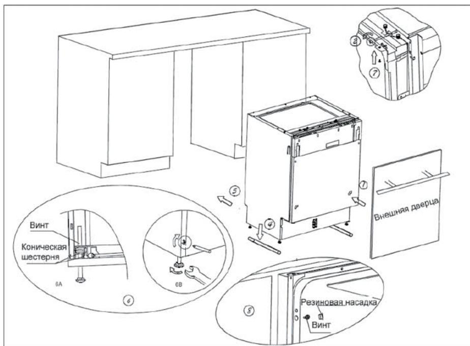
Положите на дверцу машины и внутрь кюветы уровень, чтобы проверить, ровно ли расположена машина. Выровняйте машину, регулируя каждую опорную ножку отдельно. Выравнивая положение машины, старайтесь не опрокинуть ее.
