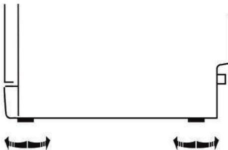
Выравнивая положение машины, старайтесь не опрокинуть ее. Для нормальной работы машина должна быть расположена ровно. Положите на дверцу машины и внутрь кюветы уровень, чтобы проверить, ровно ли расположена машина. Выровняйте машину, регулируя каждую опорную ножку отдельно. Прибор не должен иметь наклон более 2 градусов.
