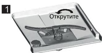
Шаг 1: Поворачивайте фильтр против часовой стрелки
