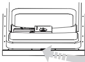
Для очистки краев дверцы пользуйтесь только мягкой влажной салфеткой. Для предотвращения проникновения воды в замок и электрические компоненты не пользуйтесь чистящим распылителем любого типа.
