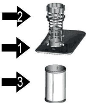
Остатки пищи и грязи, улавливаемые этим фильтром, размываются струей воды из специального сопла нижней форсунки и смываются в сток.
