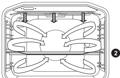
Одновременно работают верхний нагревательный элемент, инфранагреватель и вентилятор.
